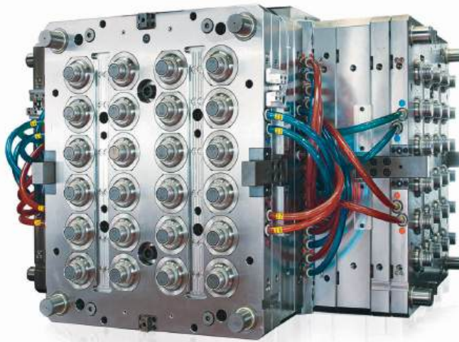
Bild 1. Station 1: Einspritzen; Station 2: Kühlen; Rückseite – Station 3: Einspritzen; Station 4: Entnahme. Dabei lassen sich auch weitere Funktionen wie Montagevorgänge ins Werkzeug integrieren. © Foboha
